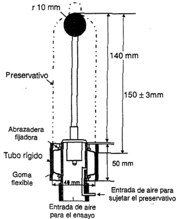
FIGURA 4 – Dispositivo para ensayo de capacidad volumétrica y presión de reventamiento
