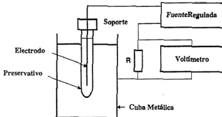
FIGURA 3 – Esquema del instrumento para la verificación de orificios
