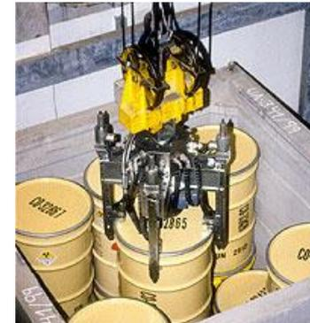
Deben ser colocados en envases apropiados, según se trate de sólidos o líquidos. Almacenados en instalaciones especialmente diseñadas para aislarlos hasta que su radiactividad decaiga hasta tal punto que ya no representen un riesgo ni para las personas ni para el ambiente.
