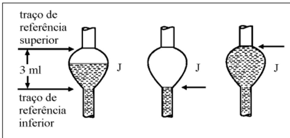
**Figura XX.** Indicação para determinação da velocidade de destilação.
